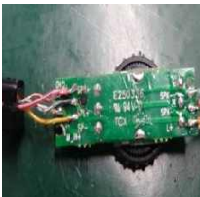
Lắp bánh xe điều chỉnh volume, hàn 5 dây tín hiệu vào bản mạch volume
