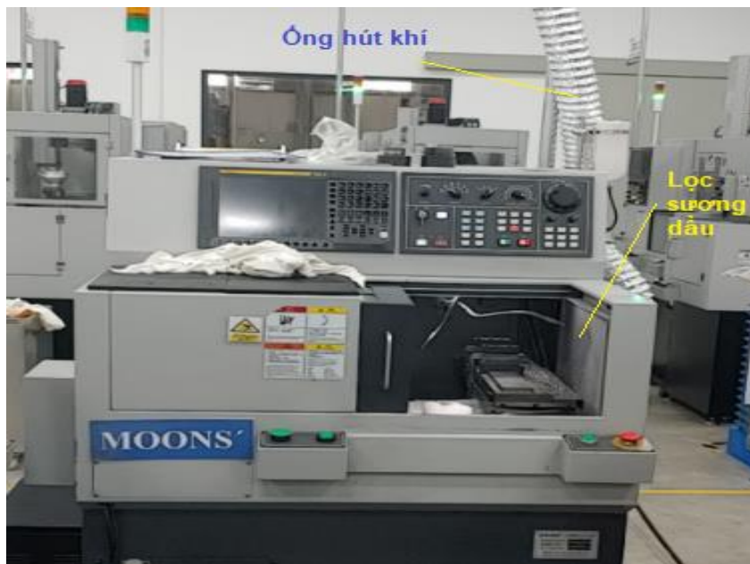
Hình 1. 9. Sơ đồ công nghệ thu gom sương dầu gia công cắt gọt, mài.
