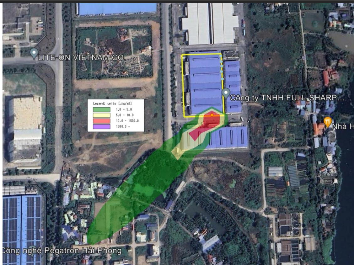
Hình 3. 2. Mô phỏng sự phát tán khí thải chứa các thành phần hữu cơ ( \text{C}_x\text{H}_y ) ra không gian xung quanh Dự án. a) Mùa hè. b) Mùa đông
