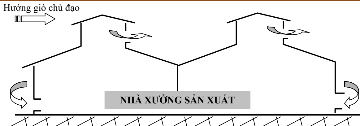
Hình 4.4. Mô hình thông gió cho nhà xưởng sản xuất + Trang bị hệ thống quạt tại các khu vực sản xuất, cụ thể như sau:
