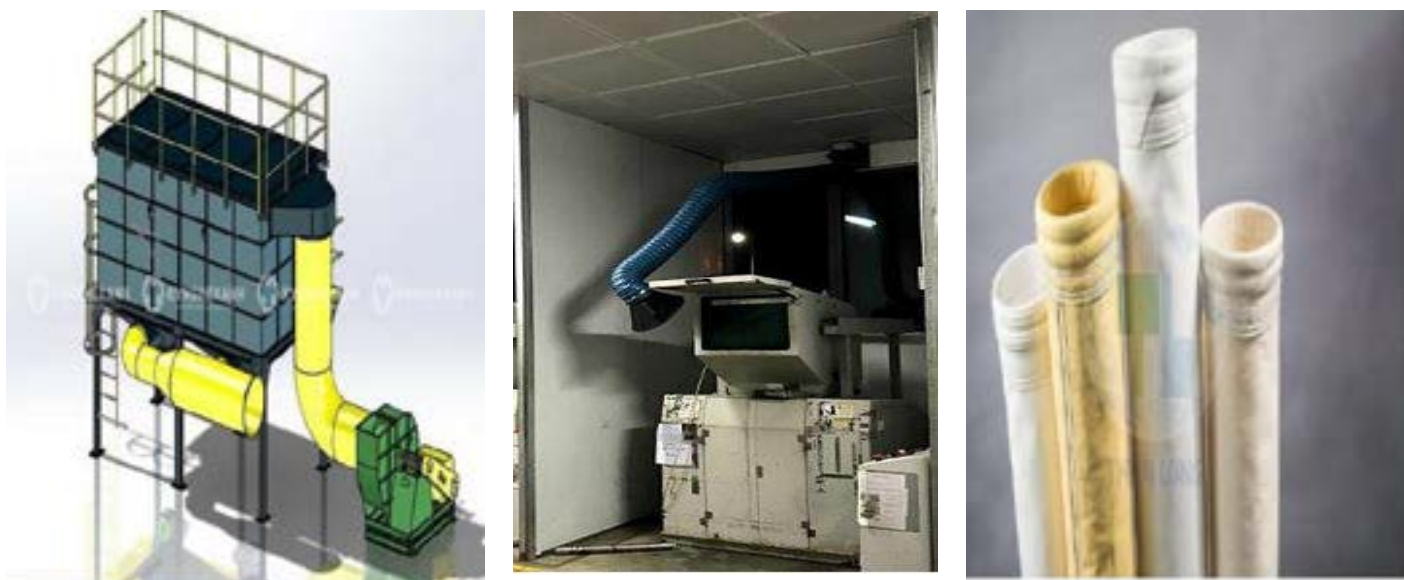
Hình 4. 9: Hình ảnh minh họa hệ thống lọc bụi túi vải, phễu hút và túi lọc bụi cho máy trộn nhựa, máy nghiền nhựa
