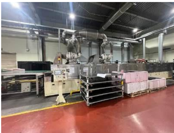
Hình ảnh hệ thống thu gom khí thải từ thiết bị rửa linh kiện sau dập
