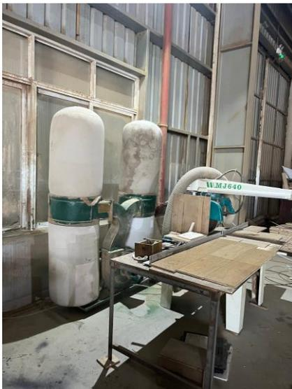
Thiết bị thu bụi tại máy cắt và máy tạo lỗ (tạo mẫu)
