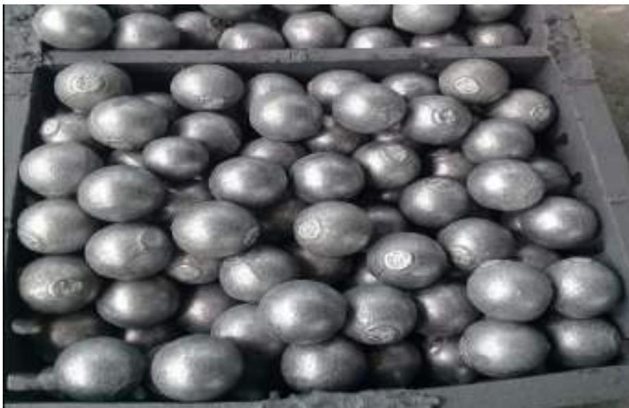
Hình 1.2. Hình ảnh bi nghiền được sử dụng trong quá trình nghiền xi măng
