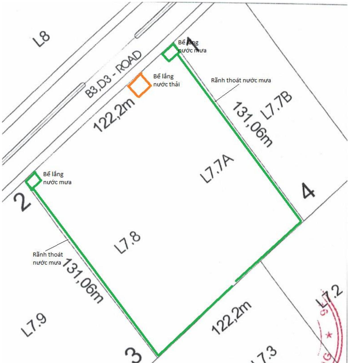
Hình 4.4. Đường dẫn nước mưa, nước thải thi công của Dự án
