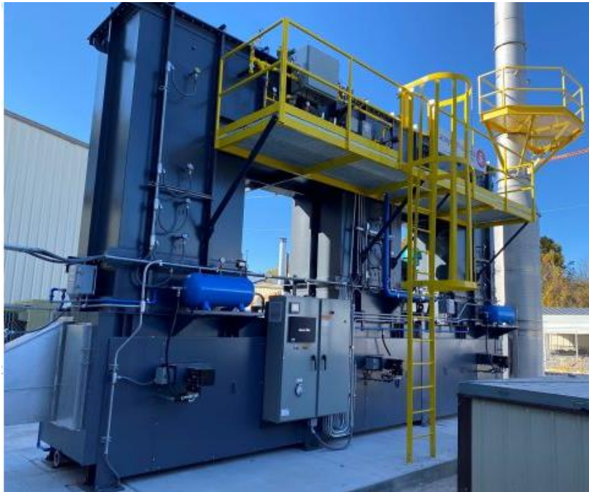
Hình 4.9. Hệ thống xử lý khí thải RTO (minh họa hệ thống tại Trung Quốc)
