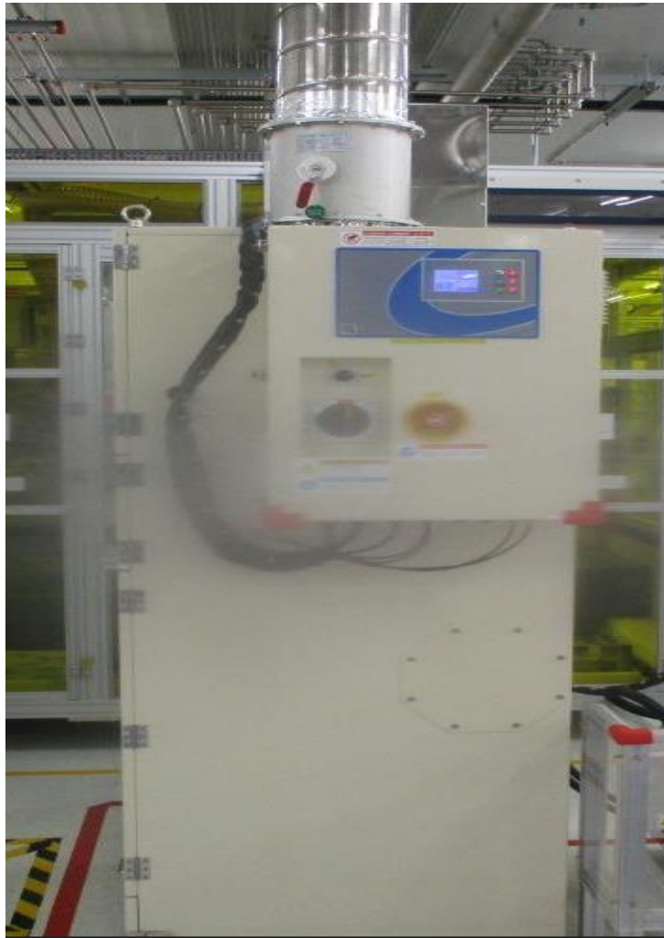
Hình 3- 12: Hình ảnh thiết bị lọc bụi máy laser cutting
